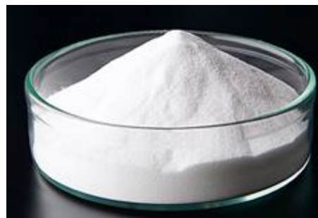
Figure 16: Ammonium paratungstate, 5(NH_4)_2O \cdot 12WO_3 \cdot 5H_2O .
